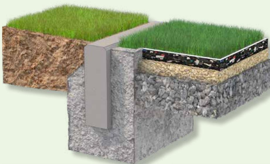
Système de Bordure Realsport permettant de fixer solidement le gazon dans le terrain
