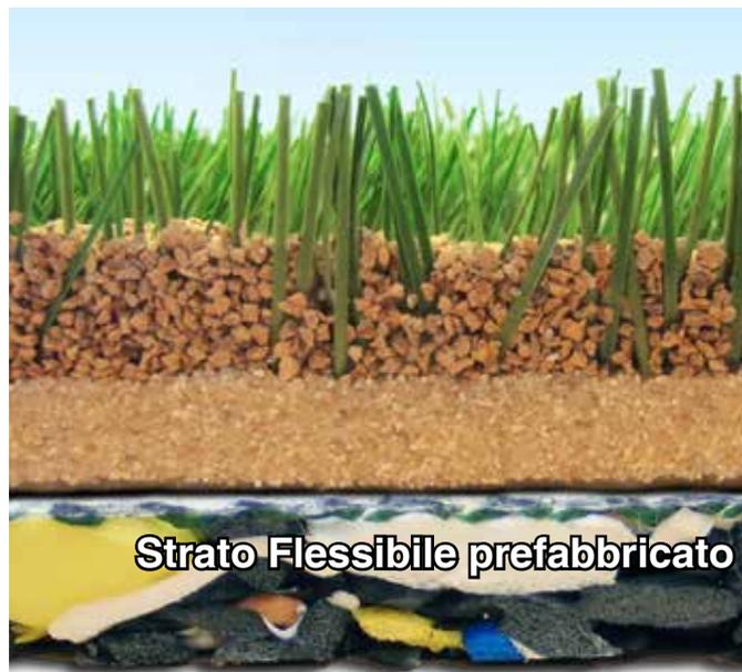
Tutti i moderni sistemi di erba sintetica, con o senza riempimento, necessitano di un sottofondo morbido per fornire le qualità sportive attese. L'assorbimento degli urti è garantito principalmente dallo strato morbido. Esistono due famiglie di strati morbidi: gli strati prefabbricati e gli strati gettati in opera.
