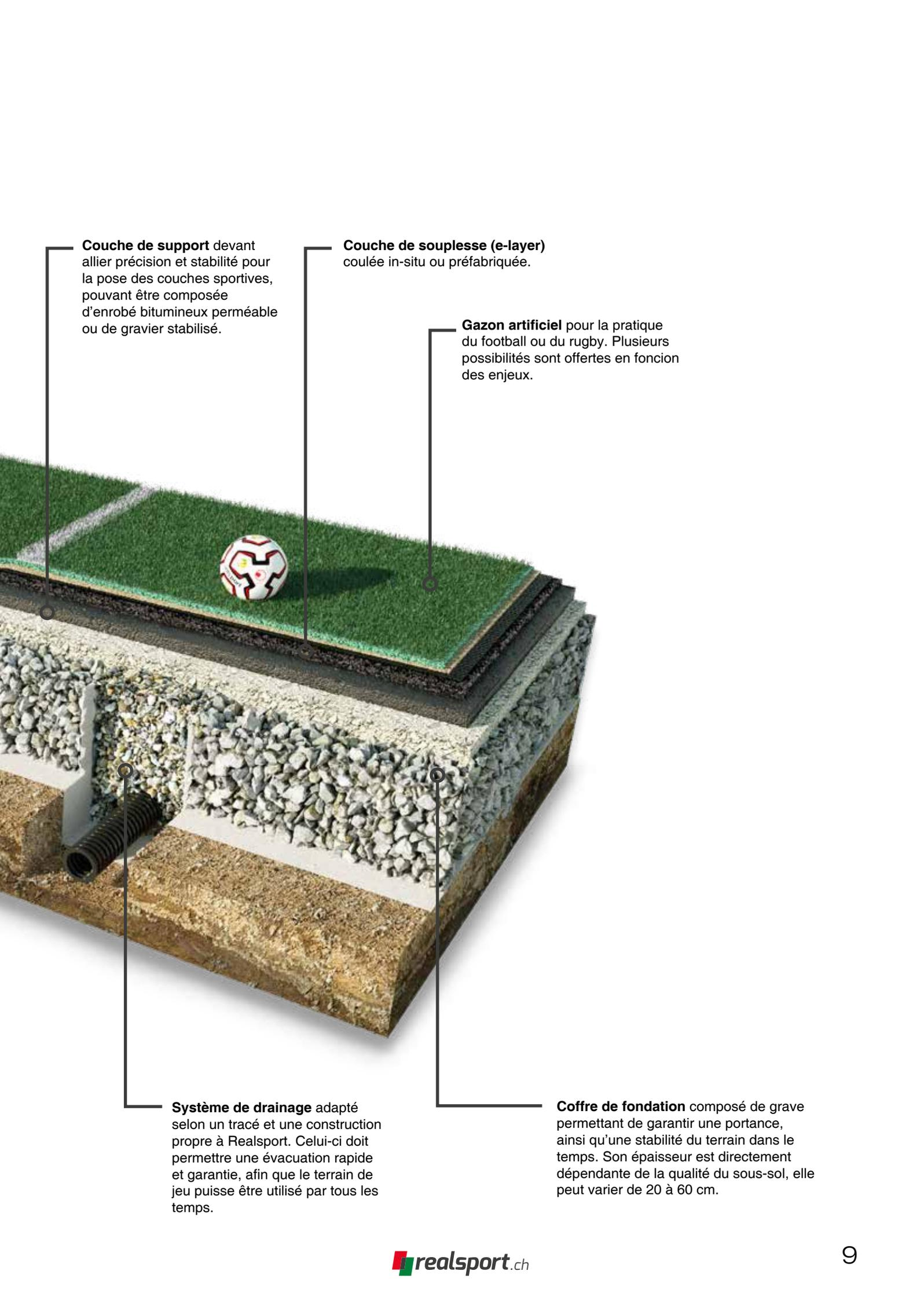
**Couche de support** devant allier précision et stabilité pour la pose des couches sportives, pouvant être composée d'enrobé bitumineux perméable ou de gravier stabilisé.
