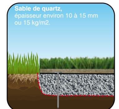
Sable de quartz, épaisseur environ 10 à 15 mm ou 15 kg/m<sup>2</sup>.
