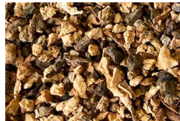
Standardkork mit einer Dichte von über 250 gr/Liter und einer hohen Anzahl an Holzpartikeln
