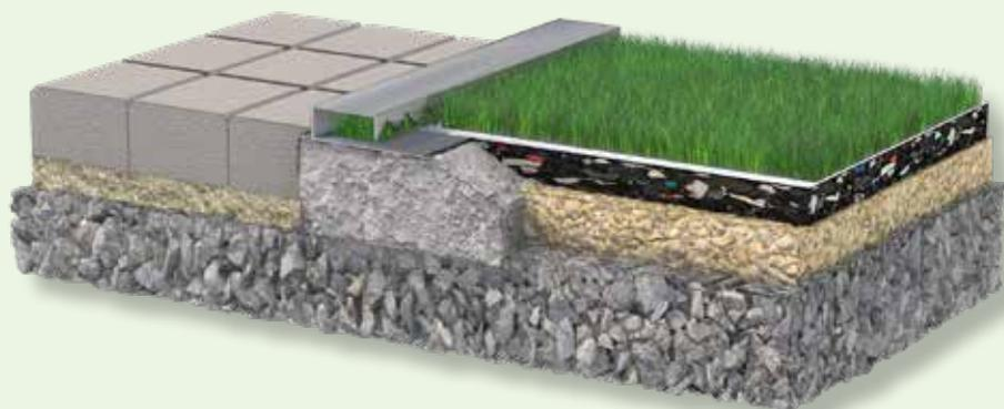
Système de talon de béton permettant d'encoller le gazon synthétique
