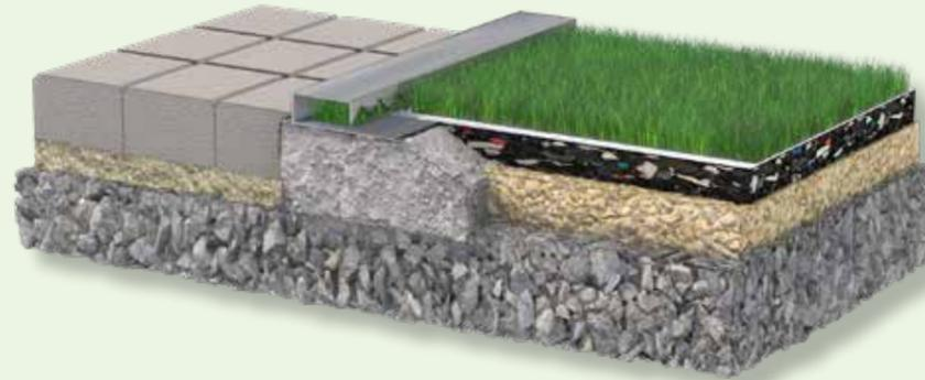
Realsport-Bordrand-System zur sicheren Befestigung des Rasens auf dem Feld
